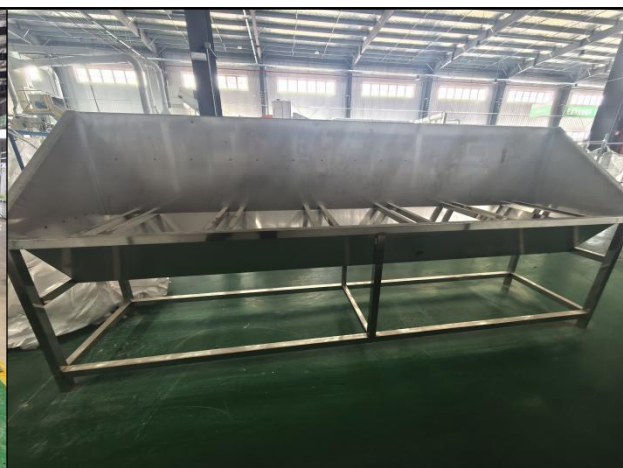
盐水环打孔平台
