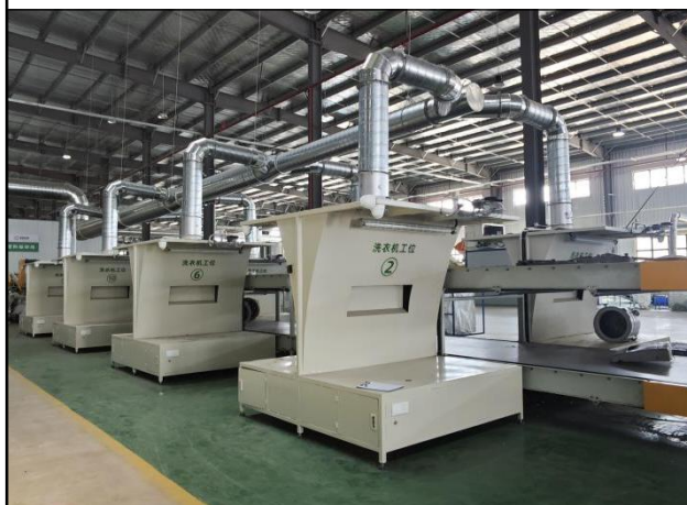
洗衣机拆解线拆解工作台
