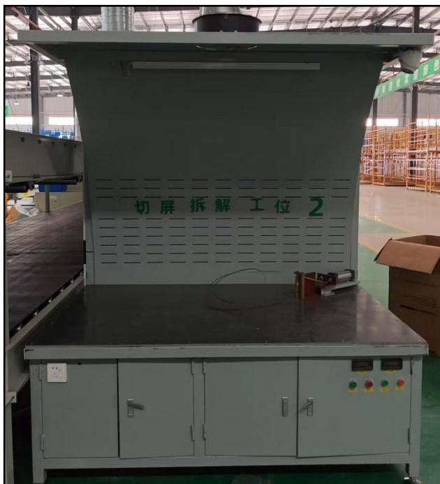
CRT 切割工作台负压吸尘罩
