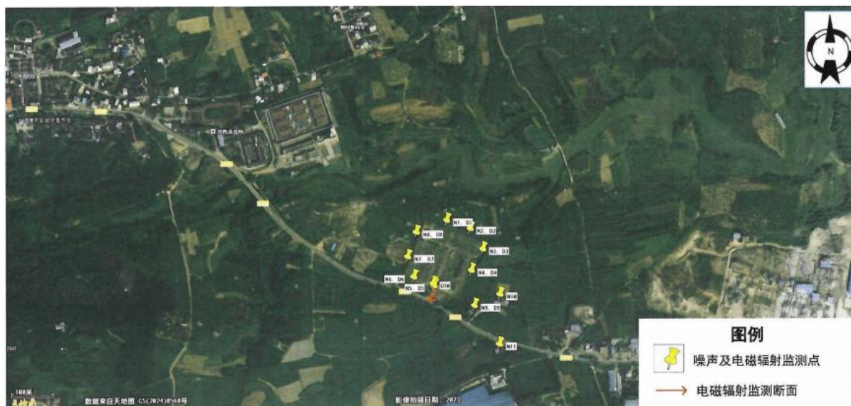
图 A3-2 220kV 里明变电站厂界及衰减断面监测点位示意图
